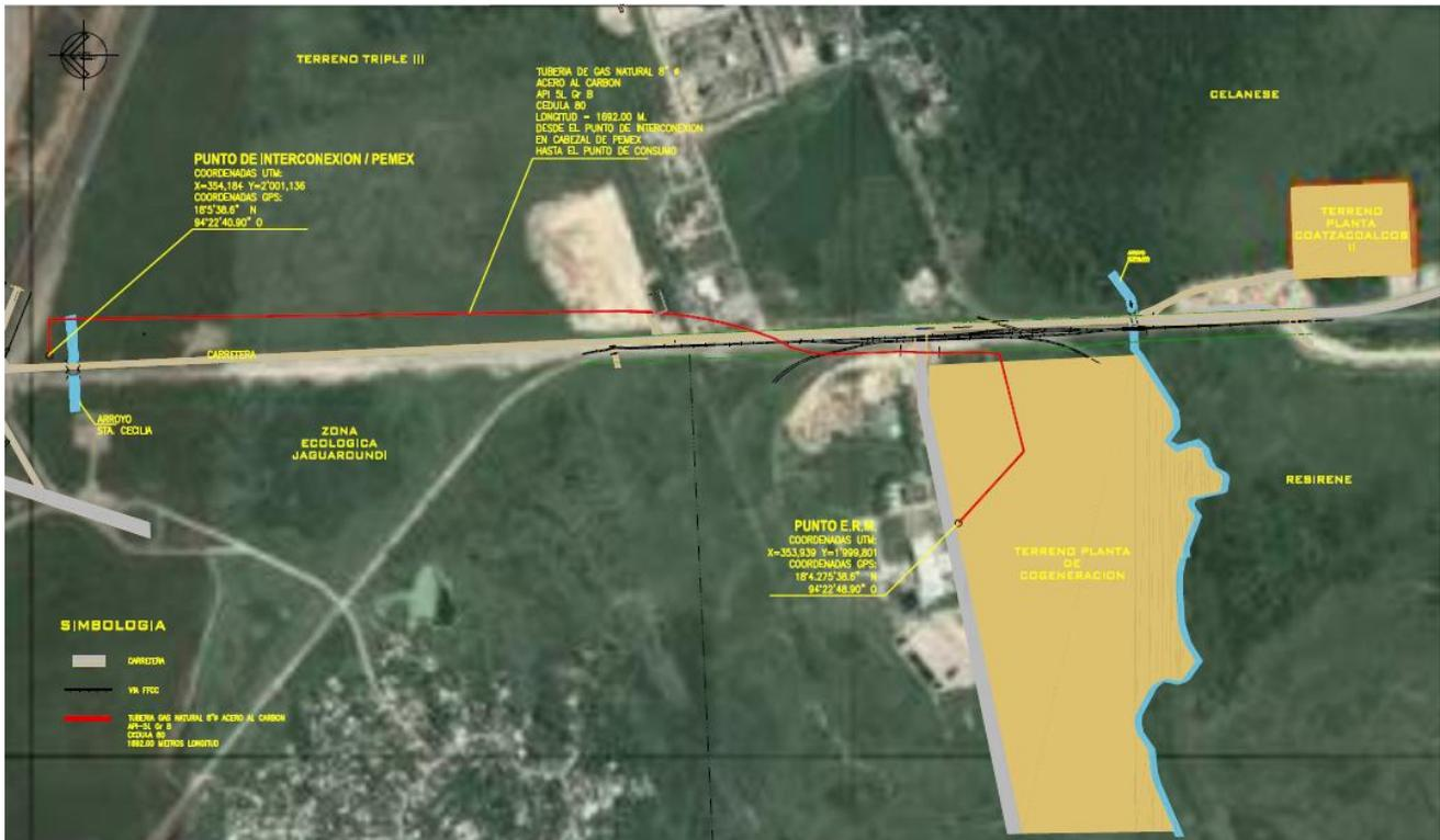
Imagen 1. Vista satelital de la ubicación del punto de interconexión del sistema de transporte de gas natural para la Planta de Cogeneración
