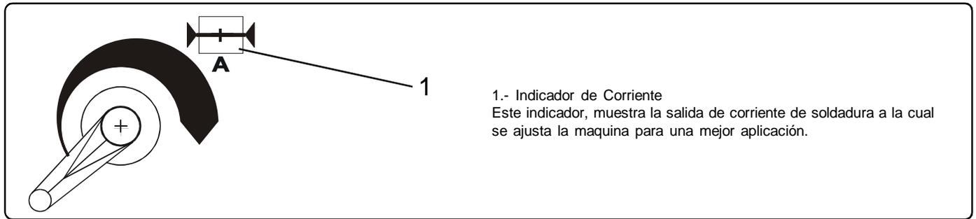
**Figura 4-4 Escala Indicadora de Corriente**
