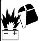
**LAS CHISPAS** pueden causar que los gases producidos por las baterías **EXPLOTEN**; los ácidos de las baterías pueden causar quemaduras en los ojos y piel.
