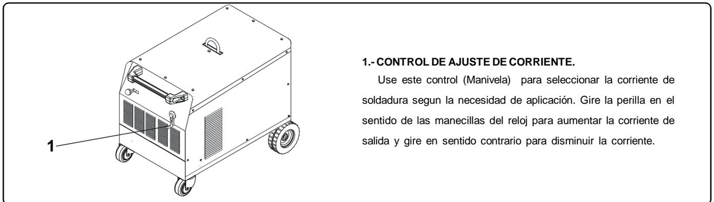
**Figura 4-5 Control de Ajuste de Corriente**
