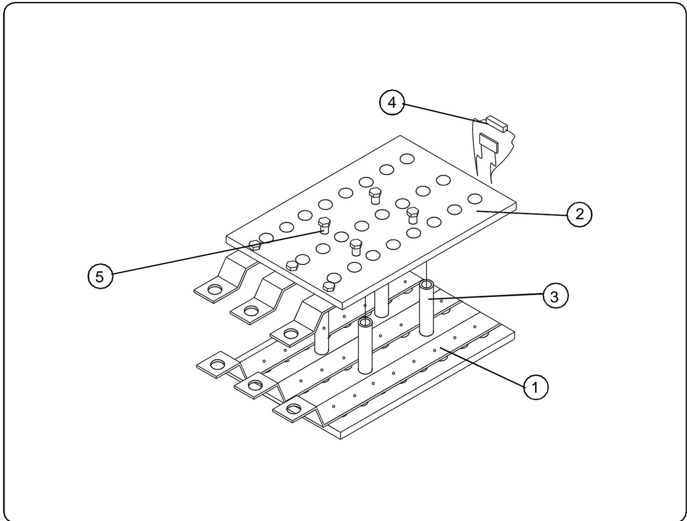
Figura B Rectificador (Partes)
