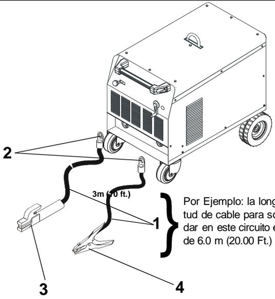
1.- Cables del Circuito de Soldadura.
