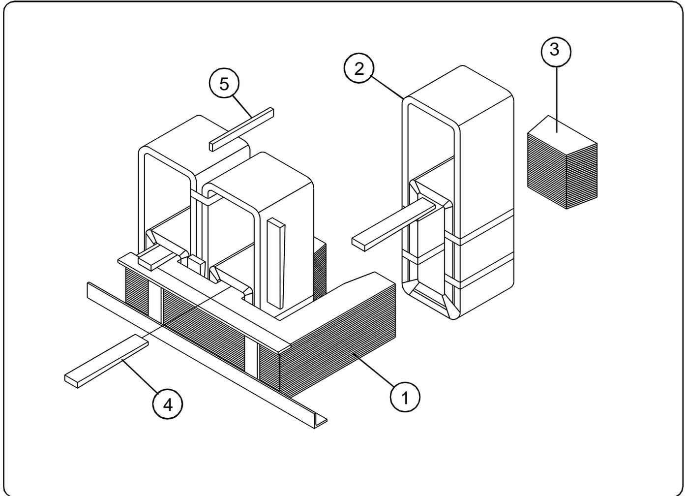
Figura A Transformador (Partes)
