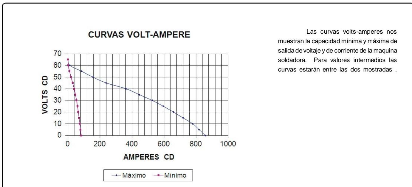
**Figura 2-1 Curvas Volts-Amperes**
