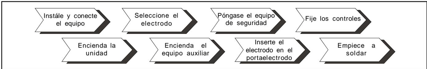
**Figura 4-9 Secuencia para soldar con electrodo revestido ( SMAW ).**
