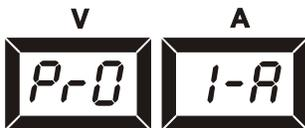
Indica una falla en la protección térmica de la circuitería localizada en el lado izquierdo de la unidad (termistor abierto). Si este mensaje es desplegado, contacte con su centro de servicio autorizado inmediatamente.
