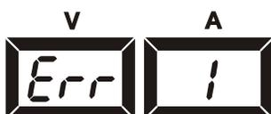
Indica una falla en el circuito primario de potencia. Si este mensaje es desplegado, contacte con su centro de servicio autorizado inmediatamente.
