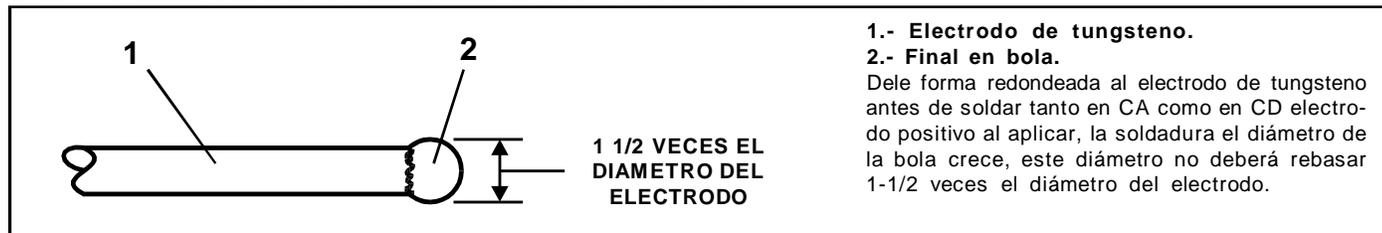
FIGURA 6-1 PREPARACION DEL TUNGSTENO PARA CA ó CD ELECTRODO POSITIVO
