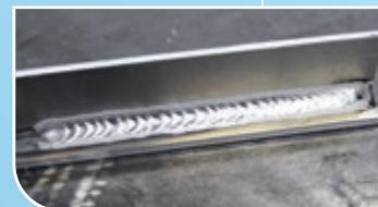
El arco con Argón Alta Pureza es más estable y permite tener un mejor control de la aplicación.
