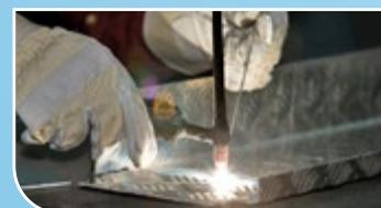
Para soldadura GTAW es posible combinar con gas de camaréo INOXX TAG X1® o mantener Argón Alta Pureza.
